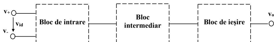
Fig. 10.8: Schema bloc a unui AO
